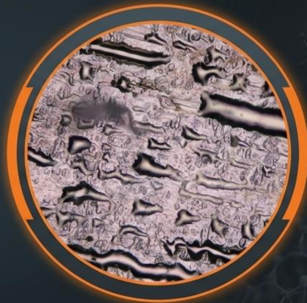
Réz oldali felszín (200x nagyítás). Szignifikáns morfológiai eltérés a hűtési dinamika miatt.
